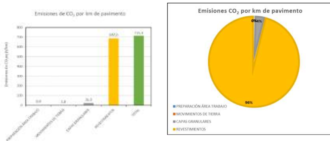
Figura 11: Emissiones de CO 2 eq según procedimientos de construcción Tramo 1 Proyecto Tegucigalpa- La Venta (Tegucigalpa - Desvío Aldea Santa Rosa) Fuente: Elaboración propia
