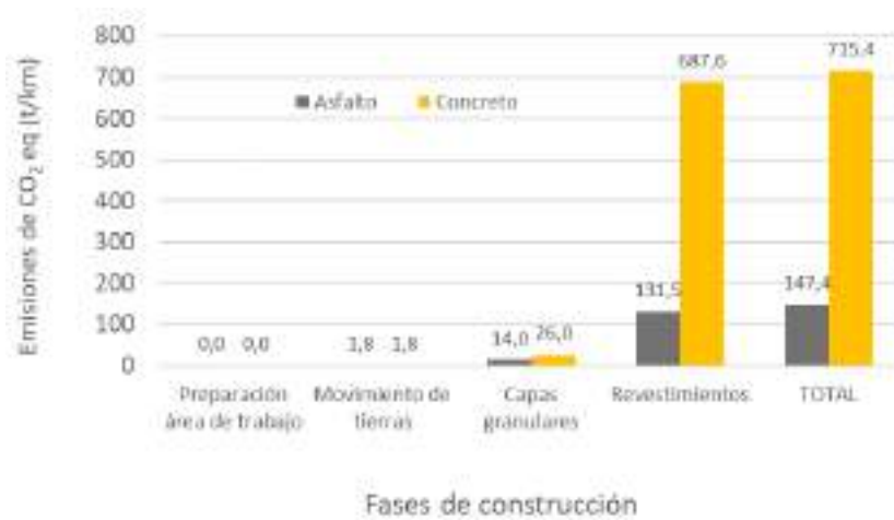
Figura 28: Emisiones de CO 2eq por km según las fases de construcción para el tramo 1
