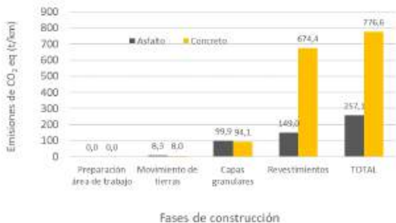
Figura 32: Emisiones de CO 2eq por km según las fases de construcción para el tramo 3
