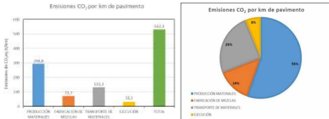
Figura 7: Emisiones totales de CO 2eq según etapas del ciclo de vida Proyecto Alto Chiza - Cuya
