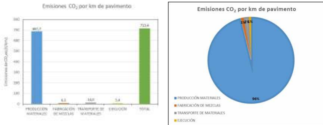
Figura 10: Emissiones de CO 2 eq según etapas del ciclo de vida Tramo 1 Proyecto Tegucigalpa- La Venta (Tegucigalpa - Desvío Aldea Santa Rosa) Fuente: Elaboración propia
