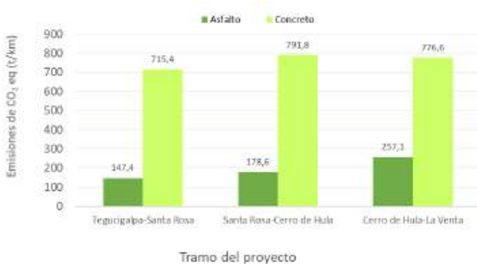
Figura 33: Emisiones de CO 2eq por km para los tres tramos y cada tipo de pavimento
