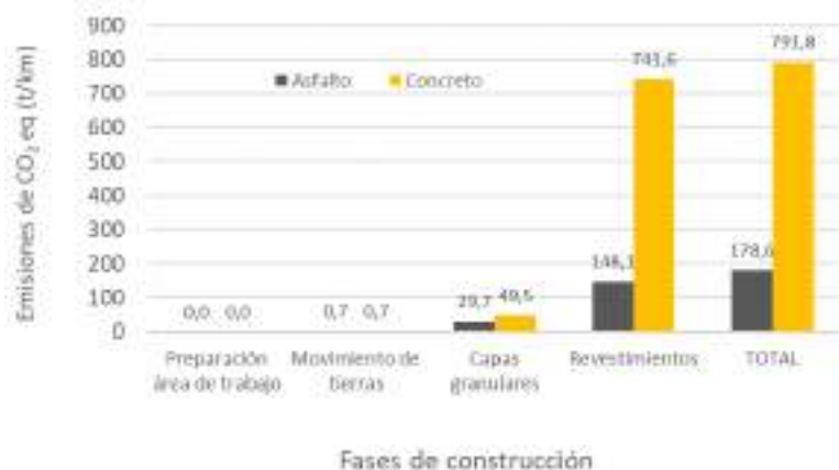
Figura 30: Emisiones de CO 2 eq por km según las fases de construcción para el tramo 2
